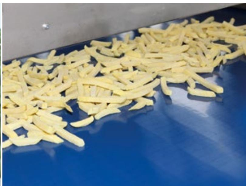
Habasit® Cleandrive é uma linha de correias transportadoras extrudadas, homogêneas e fabricadas em largura de até 1,8 m.
