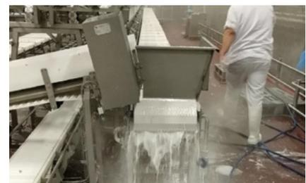
要显著减少有机物的积聚,有效清洁塑料模组式输送带,最终解决方案是增加平整的表面,改善冲水的冲刷效果,并尽量减少铰链和插销的数量。
