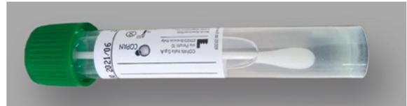
在无菌环境中, 沿着输送带顶部 300 毫米线对样本进行拭子取样。然后将拭子内容物在 30°C (86°F) 下培养 36 小时。
