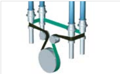
W-8/DS-8 四锭传动, 具有两个导向轮
